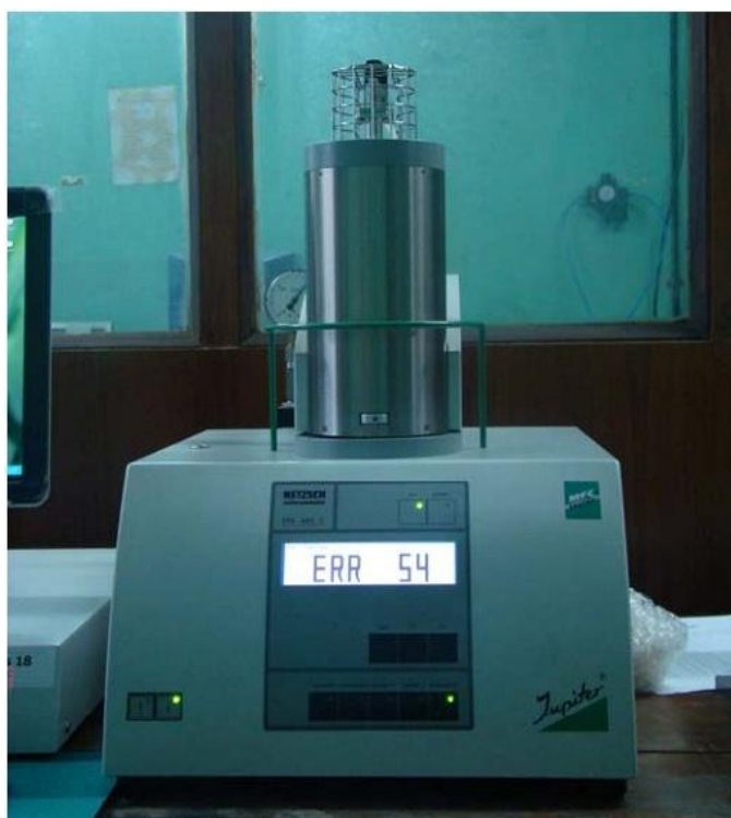
Fig. 5.6 A view of STA apparatus (CGCRI)
