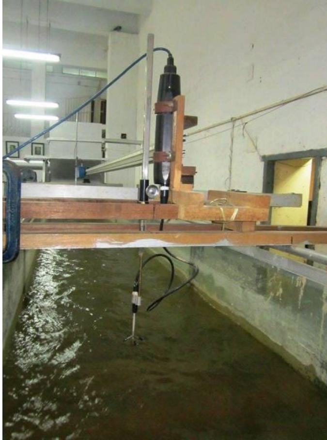
Fig. 4.8 Mini ADV capturing velocity of flow
