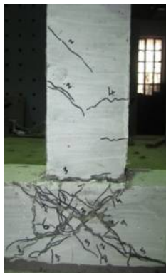
(d) EJ 4-Geo-grid confinement +steel fibers
