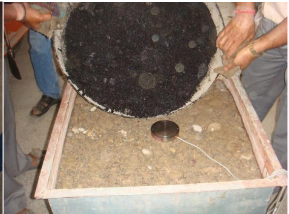
(d) Load cell at interface of WMM and DBM
