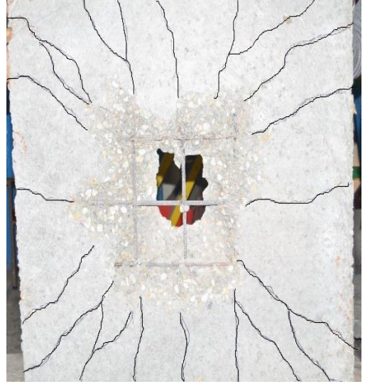
(d) Bending of reinforcement in central region
