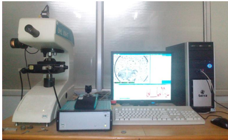
Fig. 3.4. Vickers Micro-hardness tester
