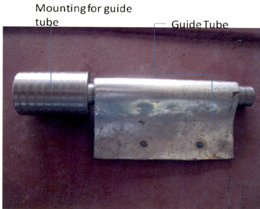
Fig.4.4: Actual guide tube
